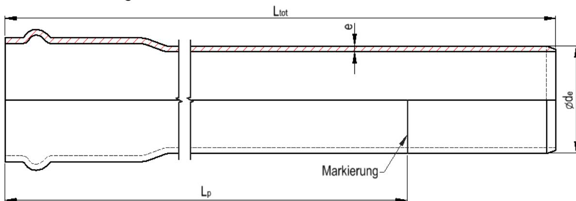
5 m - C+S Kabelschutzrohre SYMTOP aus HDPE mit roten Streifen, Muffe und Dichtung
