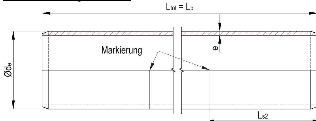
**10 m - C+S Kabelschutzrohre SYMTOP aus HDPE mit roten Streifen, ohne Muffe**
