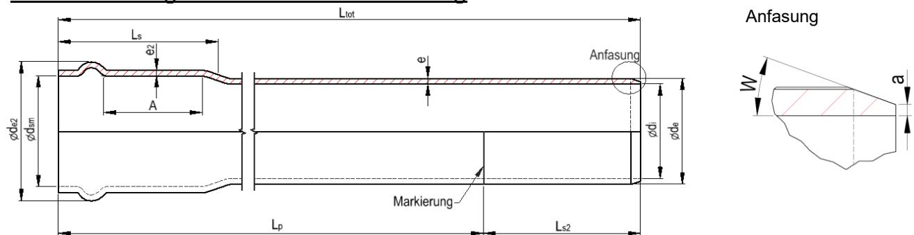
Abmessungen der Muffe und Anfasung gilt für sämtliche auf diesem Dokument aufgeführten Artikel
